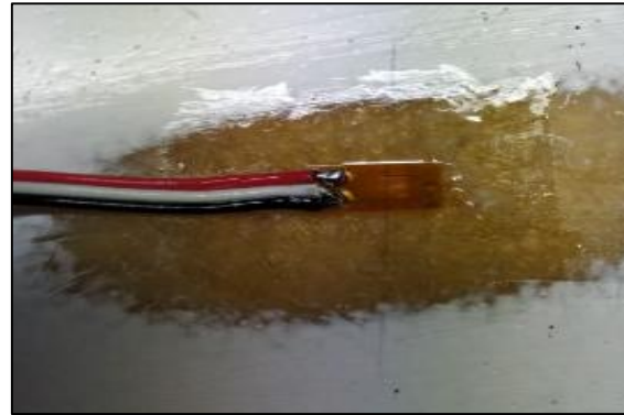
Pegado de una galga extensométrica en el álabe
